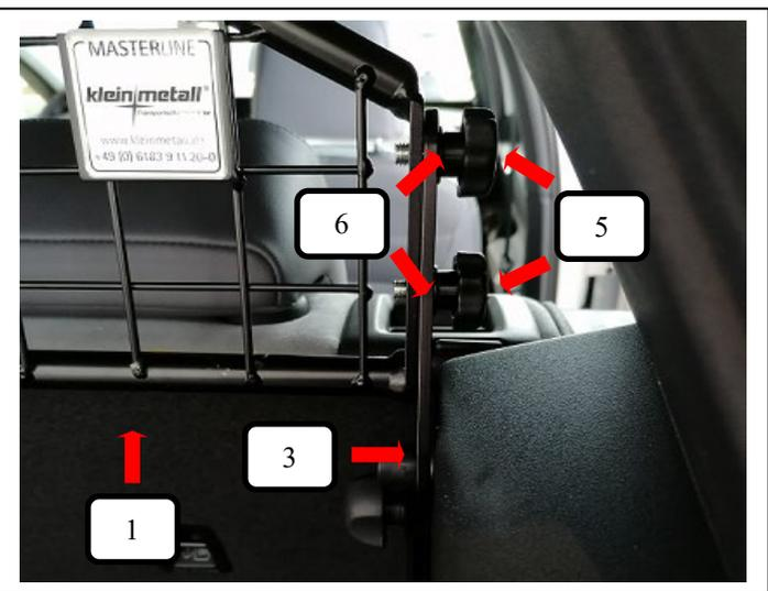
Trenngitter (Pos. 1) von hinten aus in das Fahrzeug einbringen und zwischen die beiden Stützstreben abgewinkelt (Pos. 3) führen. Jetzt von außen mit jeweils zwei Unterlegscheiben (Pos. 6) und Rändelschrauben klein (Pos. 5) mit dem Trenngitter (Pos. 1) verbinden und festziehen.
