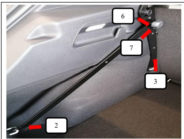
Jetzt auf beiden Seiten die Stützstrebe gerade (Pos. 2) wie auf dem Bild in die Verzurröse einhängen. Mit der Rändelschraube groß (Pos. 7) und Unterlegscheibe (Pos. 6), an der Stützstrebe abgewinkelt (Pos. 3) befestigen.
