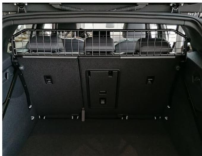
Trenngitter im montierten Zustand.
