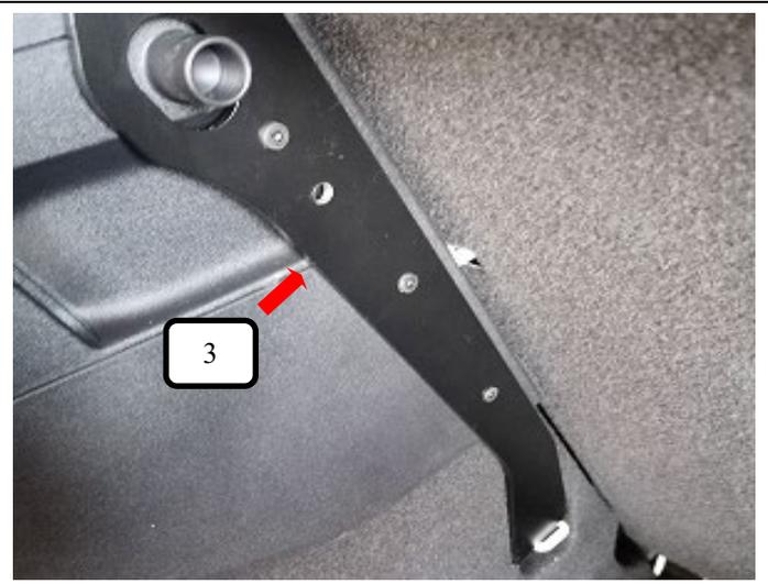
Stützstrebe abgewinkelt (Pos. 3) auf der rechten und linken Seite wie auf dem Bild unten in die Verzurröse einklinken und oben an die Seitenverkleidung führen.
