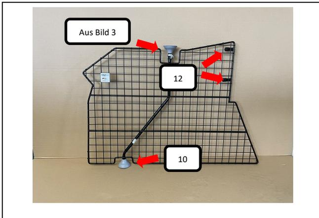
Wie im Bild dargestellt, bitte die aus Bild 3 zusammengesteckte Gewindestange mit Gummifuß oben in die Rohröffnung des Teilers (Pos. 1) stecken (Feststellpunkt) und einen Gummifuß (Pos.10) unten am Teiler aufstecken. Beide Rohrendkappen (Pos. 12) auf den Raumteiler drücken.
