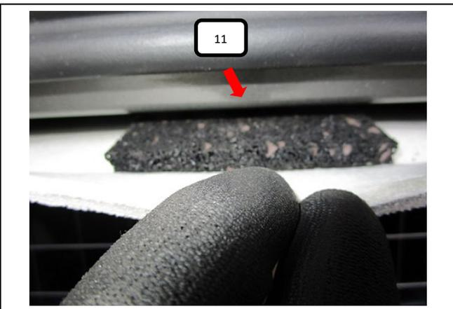
Im oberen Bereich der Heckklappe die Gummiabdichtung leicht anheben und je nach gewünschter Position des Teilers die beigelegte Gummimatte (Pos.11) im Bereich des Feststellpunktes in den Hohlraum schieben.
