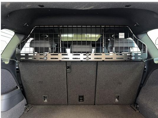
Masterline Universaltrenngitter im montierten Zustand.
